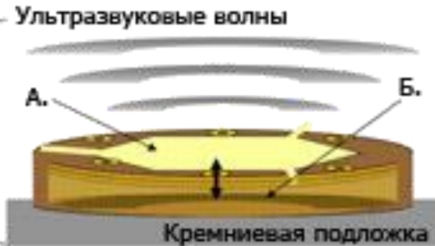
А. Гибкая мембрана с электродом Б. Вакуумная полость
